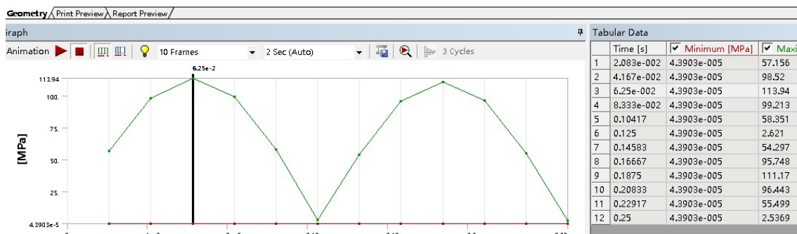
图 14 SPZ80 年钢立柱 5kPa 强度分析荷载下的应力分布图
