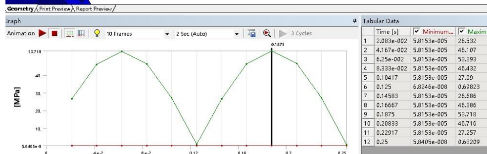
图 16 SPZ80 年钢立柱在疲劳分析荷载下的应力分布图
