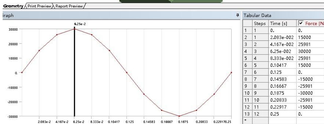
图 7 正弦交变荷载（强度分析荷载 4HZ、30 kN）
