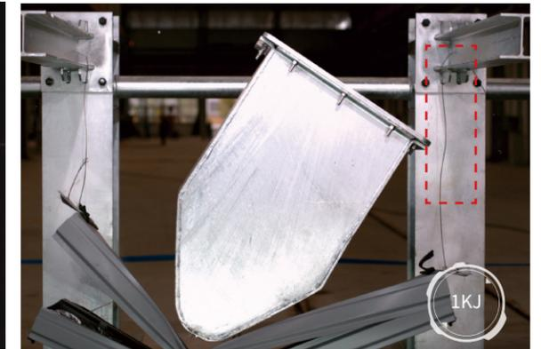
屏体受到冲击后首先发生变形，随后钢丝绳拉直后断裂，屏体从立柱中脱落
